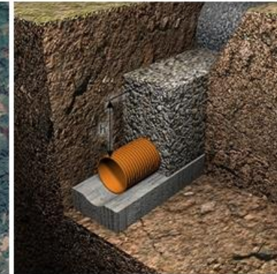
Modelo de propuesta de Instalación de Drenaje fluvial en vías no consolidadas
